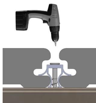
Etape 4 : Après avoir inséré et fixé la lame suivante à l'aide du clip 3 crochets standard, visser complètement la deuxième rangée de clips. Répéter ces opérations pour chaque rangée de lame qui doit être démontable.
