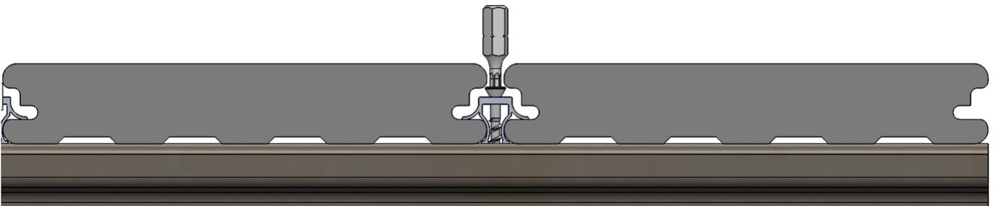
**Etape 1 :** Desserrer légèrement le clip et le décaler pour positionner la tête de vis au dessus du «trou de serrure».
