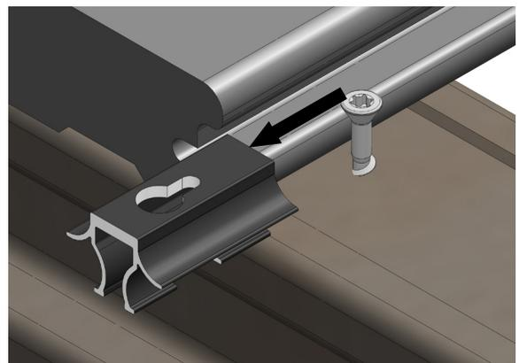
La lame est ainsi libérée. Il est possible de la retirer. Pour remonter la lame, effectuer ces opérations dans le sens inverse.
