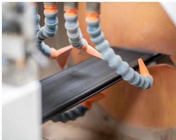
Étape de séchage sur ligne d'extrusion
