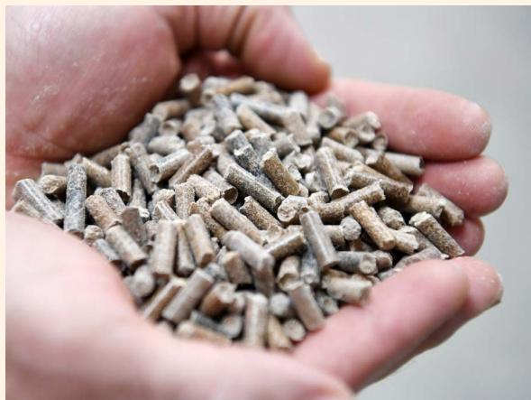
Granulés de bois composite avant extrusion
